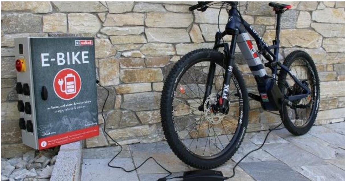
Abb. 14: Ladestationen mit normalen Steckdosen
